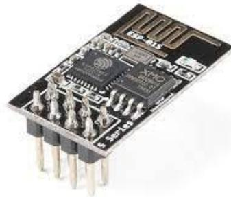
**Figure 2.6 Wi-Fi module<sup>6</sup>**
