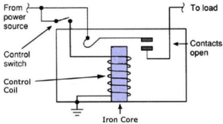
Figure 2.2 SPDT Relay <sup>2</sup>
