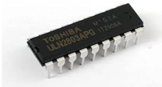
**Figure 2.4 Relay Driver<sup>4</sup>**
