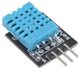
**Figure 2.7 DHT11<sup>7</sup>**
